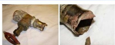
Bronceventil med messingstuds (må man aldrig blande metaller). Studsen tærer væk!
